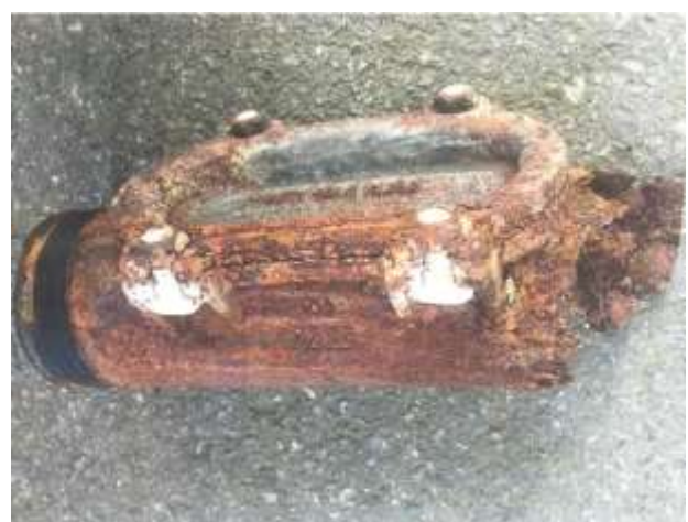
Portillon de nettoyage remplacé en 2018
